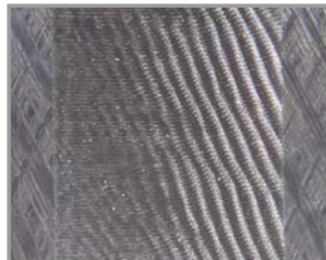
Oberfläche mit Vibrationsmarken
