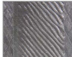
Oberfläche mit Vibrationsmarken
