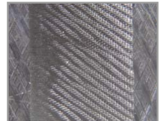
Oberfläche mit Vibrationsmarken
